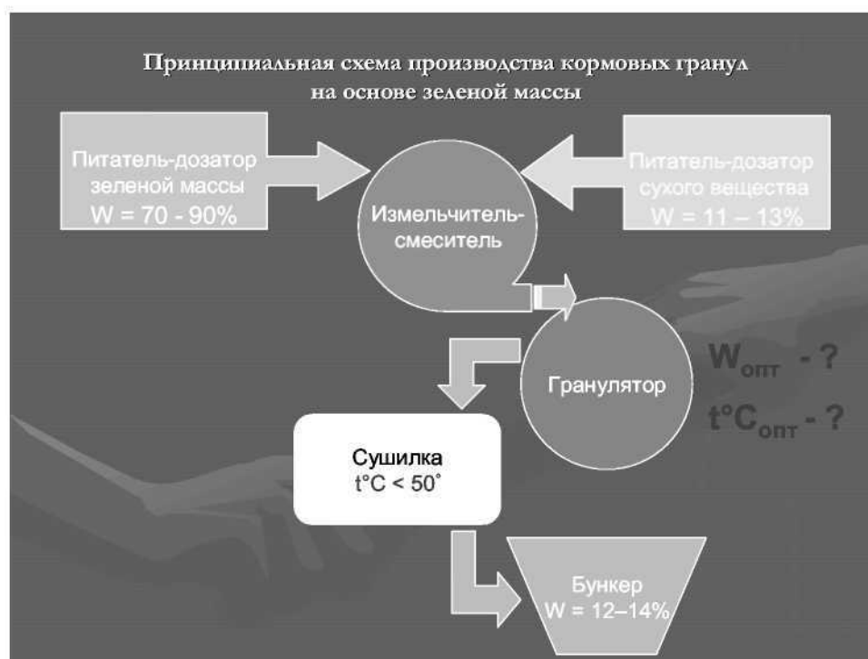
Рис. 2. Принципиальная схема производства кормовых гранул
