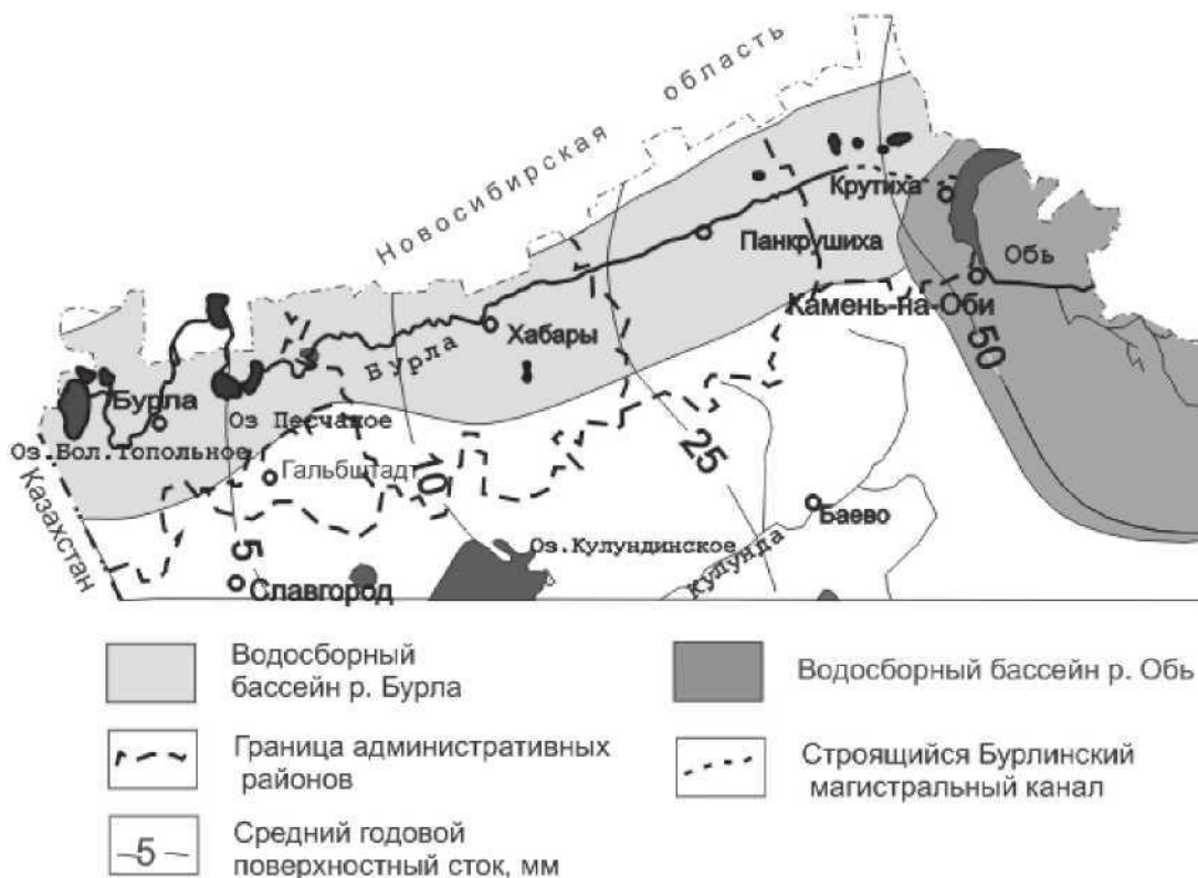
Рис. 4. Схема административного районирования и водосборных бассейнов зоны влияния Бурлинской ООС (выполнено в векторной графике с использованием материалов [6, 9])
