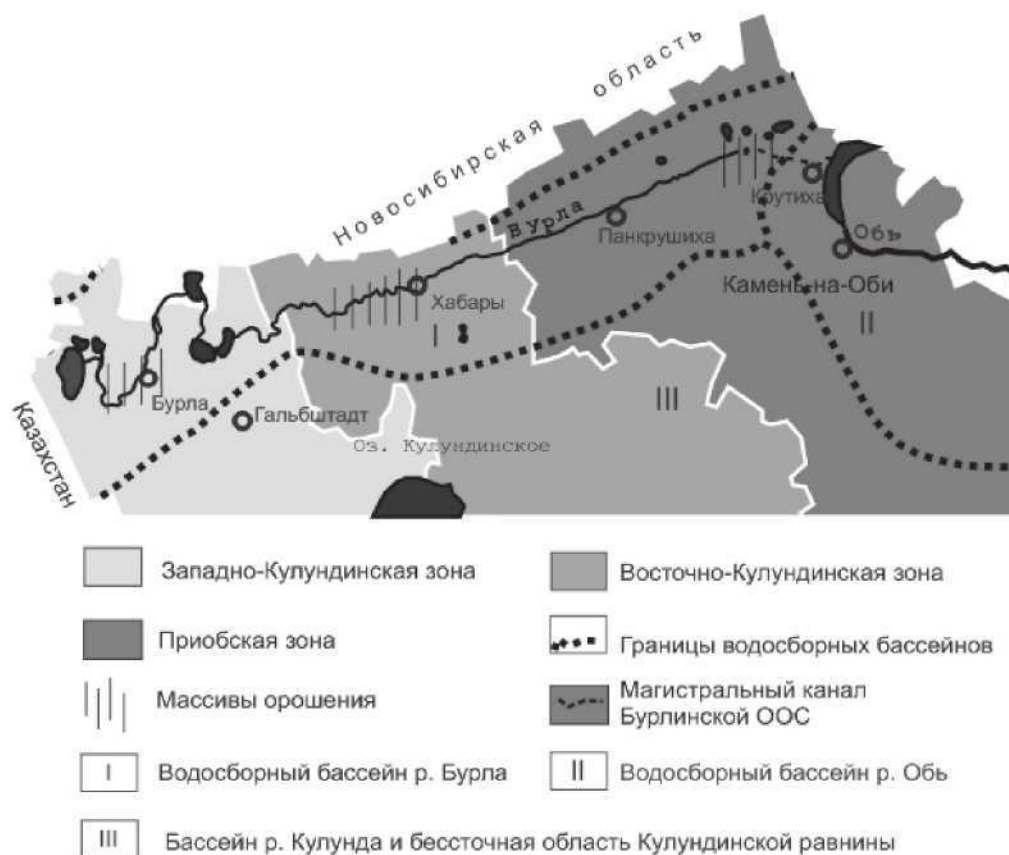
Рис. 2. Схема природно-мелиоративного районирования и водосборных бассейнов зоны влияния Бурлинской ООС (выполнено в векторной графике с использованием материалов [8])
