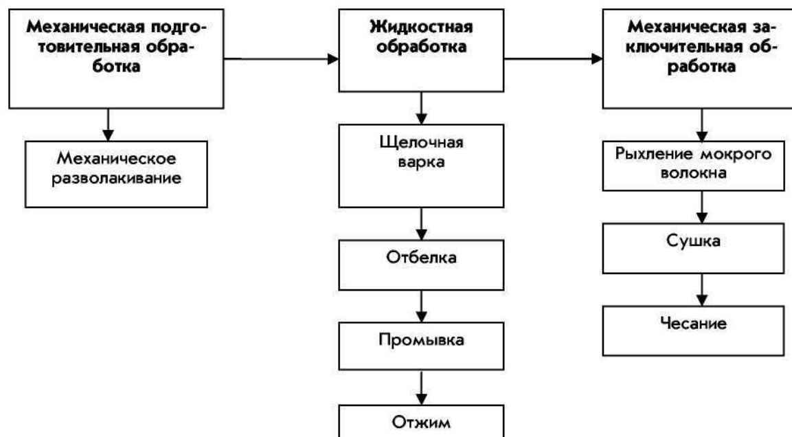
Рис. 1. Технология производства ваты
