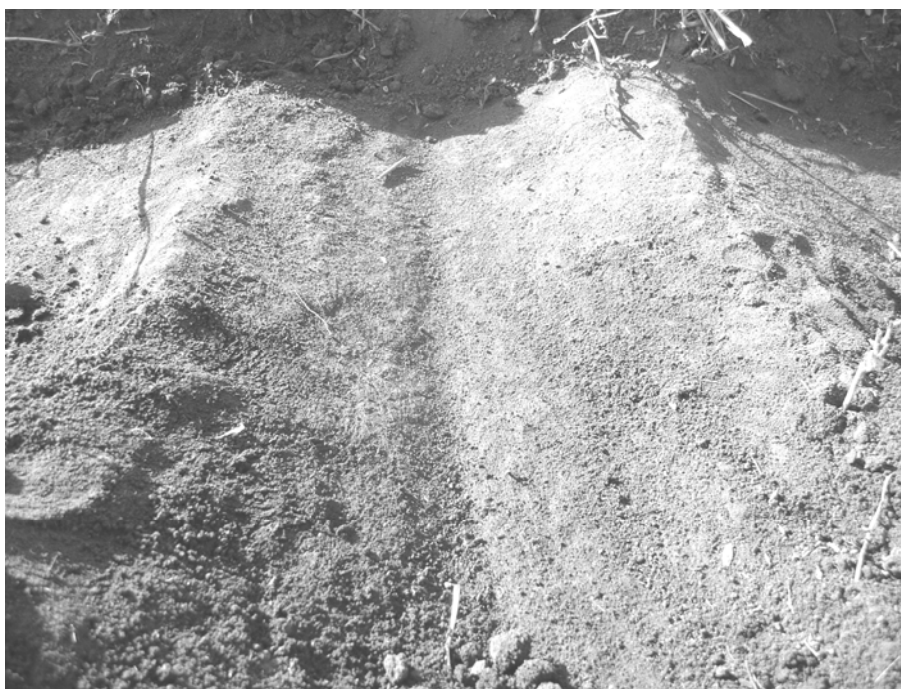
Рис. 1. След рабочего органа сеялки-культиватора СЗС-2,1 в почве
