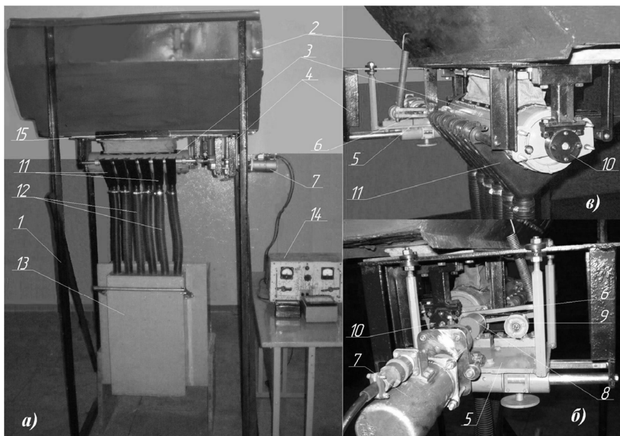
Рис. 2. Лабораторная установка для исследования вибрационного высевающего аппарата: а) главный вид; б) вид слева; в) вид справа: 1 – рама, 2 – семенной ящик, 3 – вибрационный высевающий аппарат, 4 – направляющая плотформа, 5 – подвижная плотформа, 6 – шатун, 7 – электродвигатель, 8 – корпус подшипников эксцентрикового вала, 9 – корпус подшипников технического вала, 10 – корпус подшипников основного вала, 11 – воронка семяпровода, 12 – семяпровод, 13 – пробоотборник, 14 – блок питания
