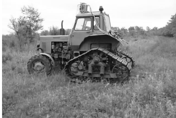
Рис. 3. Рабочие фрагменты испытаний трактора МТЗ-80 с треугольным металлогусеничным движителем
