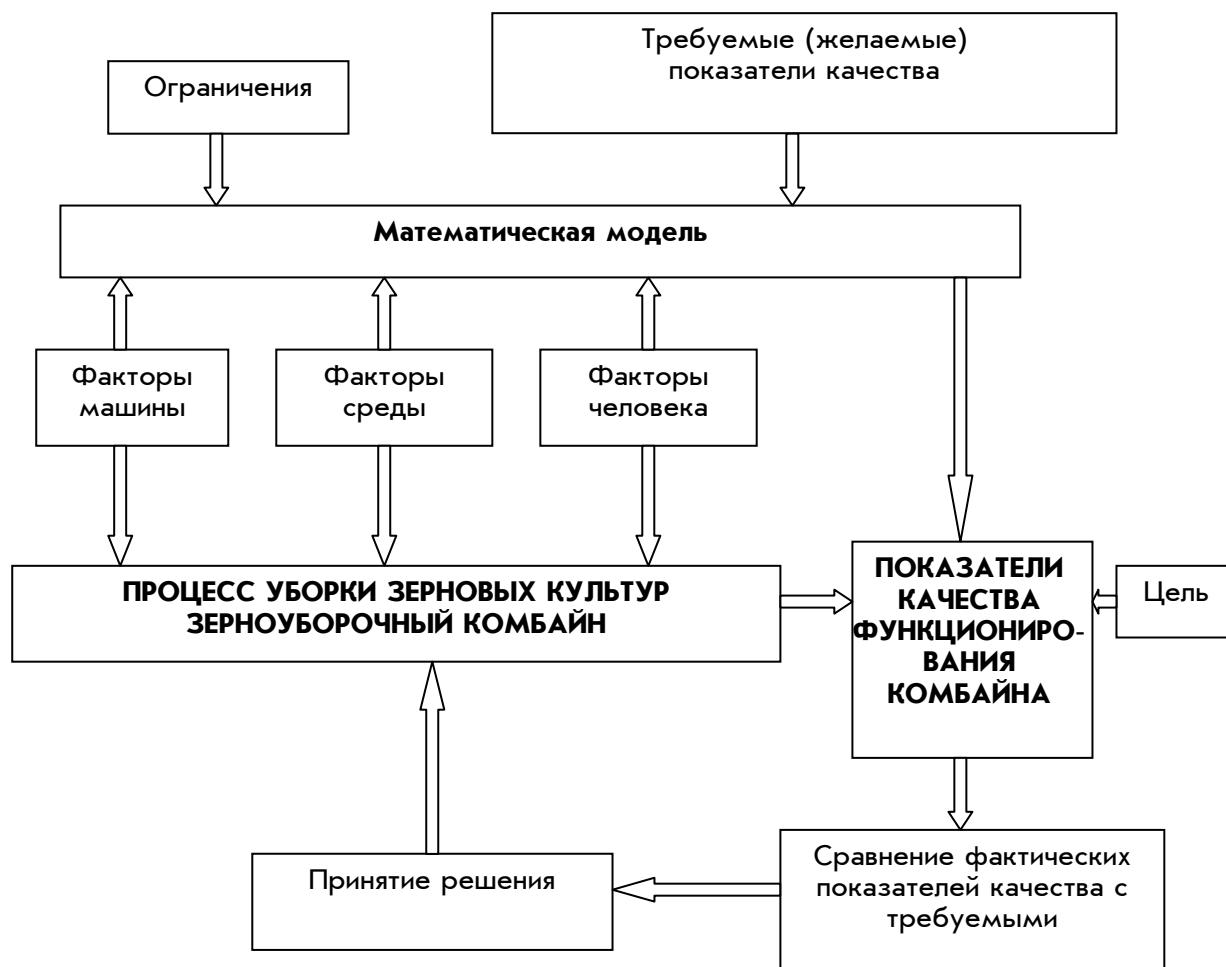
Рис. 3. Структурная схема принятия решения по совершенствованию процесса уборки зерновых культур или конструкции зерноуборочного комбайна
