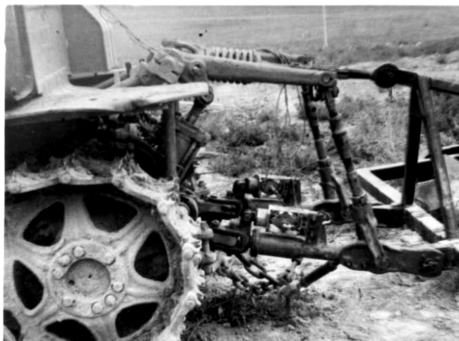
Рис. 2. Дисковый плуг-рыхлитель с тензометрическими звеньями навесной системы трактора ДТ-75М с навесной рамой дискового плуга-рыхлителя
