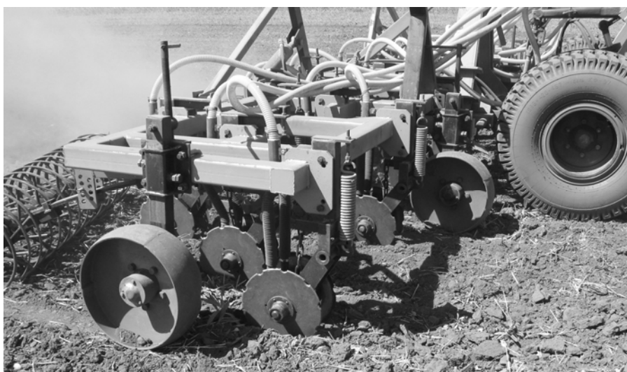
Рис. 2. Почвообрабатывающий посевной агрегат «Лидер-6,5НД» в работе с посевным агрегатом «Обь-6,5П-У»
