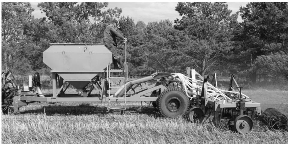
Рис. 1. Посевной агрегат «Обь-6,5П-У» с культиватором «Лидер-6,5Н» в работе с трактором Т-150К
