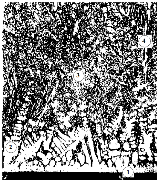
Рис. 4. Микроструктура наплавленного сплава ПГ-С27 на стали 15ХСНД: 1 – граничная полоска; 2 – дендриты аустенита; 3 – карбидная эвтектика; 4 – первичные карбиды
