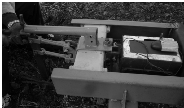
Рис. 7. Регулировка глубины хода ротационного рабочего органа
