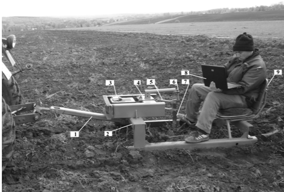
Рис. 3. Сани для измерения тягового сопротивления [3]: 1 – сница; 2 – рама; 3 – измерительный комплекс; 4 – каретка; 5 – подвеска рабочего органа; 6 – винт регулировочный глубины хода; 7 – испытуемый рабочий орган; 8 – компьютер; 9 – сиденье для оператора
