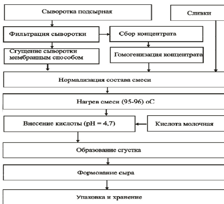
Рис. 1. Технологическая схема производства мягкого сыра с использованием сыворотки
