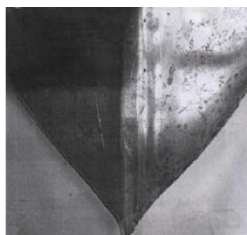
Рис. 3. Характерный износ носовой части сварных стрельчатых лап, выполненных из стали 50ХГА: а – в разделку кромок из сплава ПГ-С27; б – разделка кромок заварена проволокой Св08Г2С \varnothing 1,5 мм
