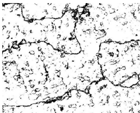
Рис. 1. Микроструктура образца А из стали 110Г13Л (100 x )
