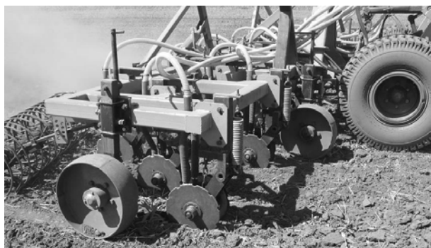
Рис. 1. Почвообрабатывающий посевной агрегат «Лидер-6,5Н» в работе с посевной машиной «Обь-6,5 П-У»
