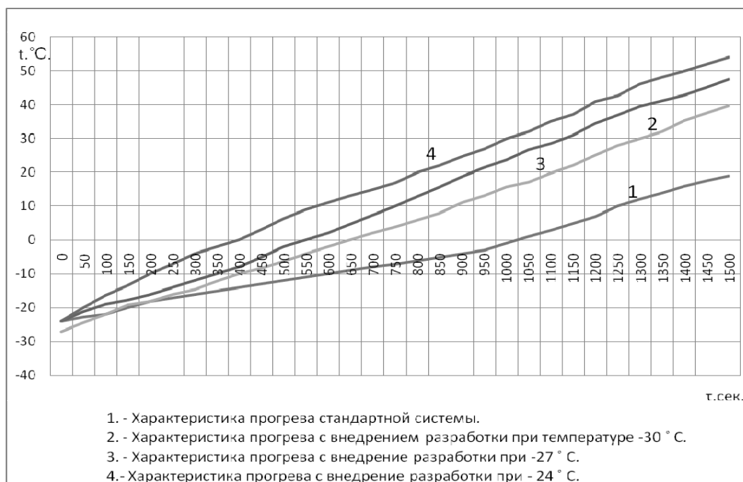
Рис. 10. Экспериментальные зависимости интенсивности прогрева агрегата трансмиссии трактора Т-150К
