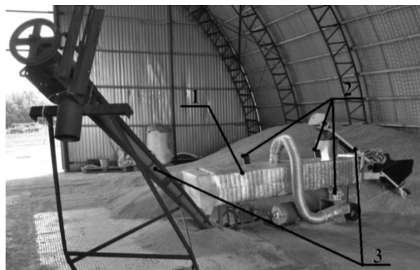
Рис. 2. Фрагмент технологической линии подработки зерна: 1 – УСЗ; 2 – контрольно-измерительная аппаратура; 3 – погрузчик зерна со спирально-винтовым рабочим органом
