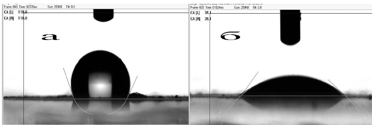
Рис. 3. Форма капли воды на гидрофобной (а) и гидрофильной (б) поверхности
