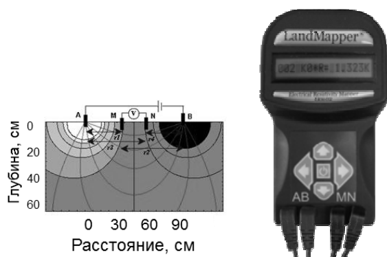
Рис. 2. Схема измерений и внешний вид прибора LandMapper
