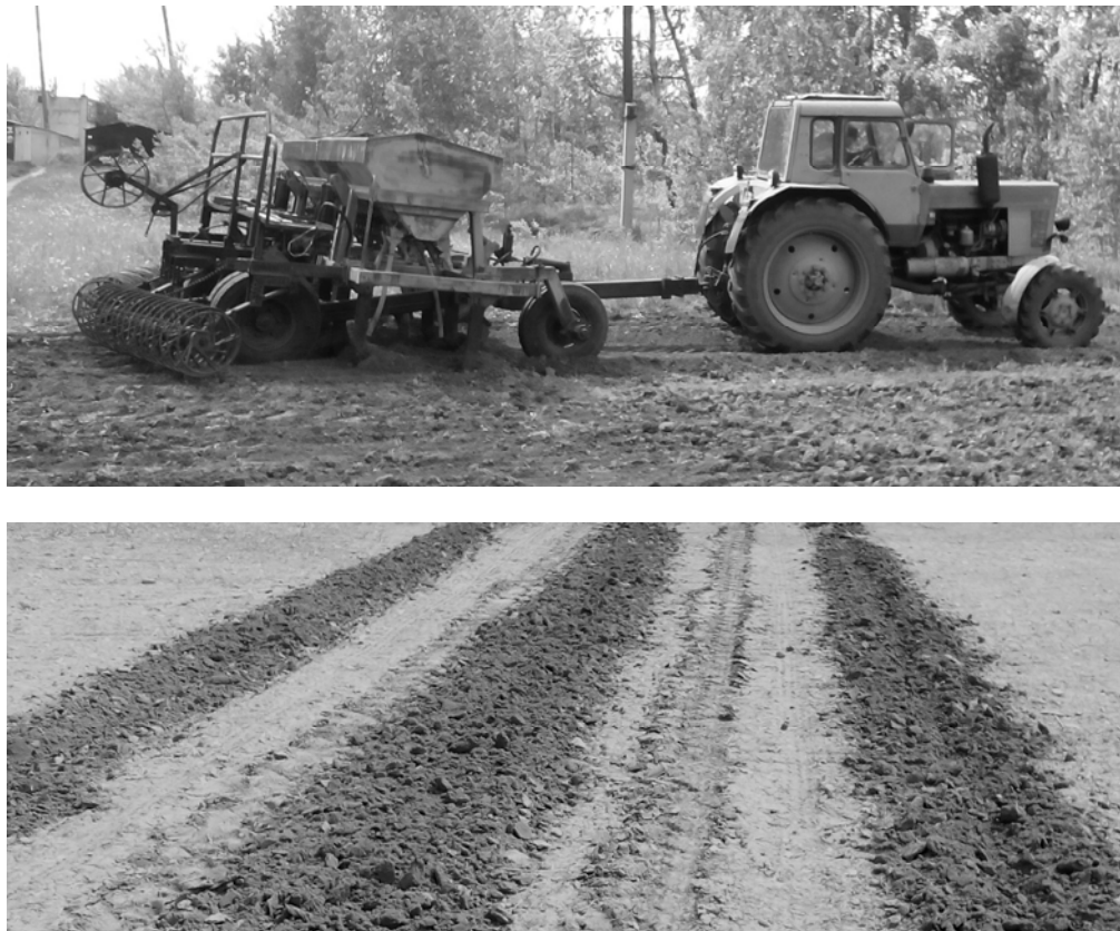
Рис. 2. Почвообрабатывающе-посевной агрегат «МВУ-4» и след от лап после прохода агрегата: слева от лапы – 370 мм, по центру – 410 и справа – 260 мм
