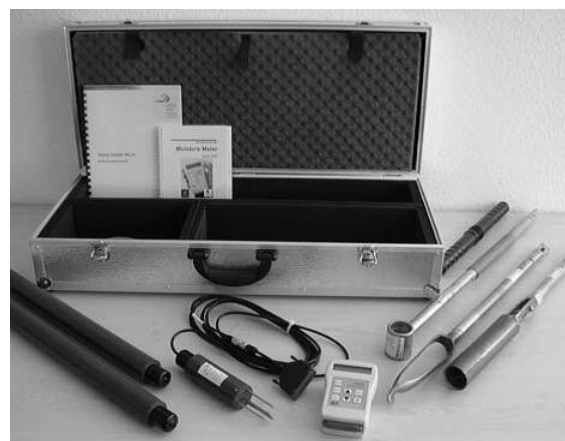
Рис. 4. Комплект для экспресс-анализа содержания влаги в почве (ручной прибор-индикатор НН2 Moisture Meter, Гидрозонд FDR ML2x «Эко-Тех», ФРГ)
