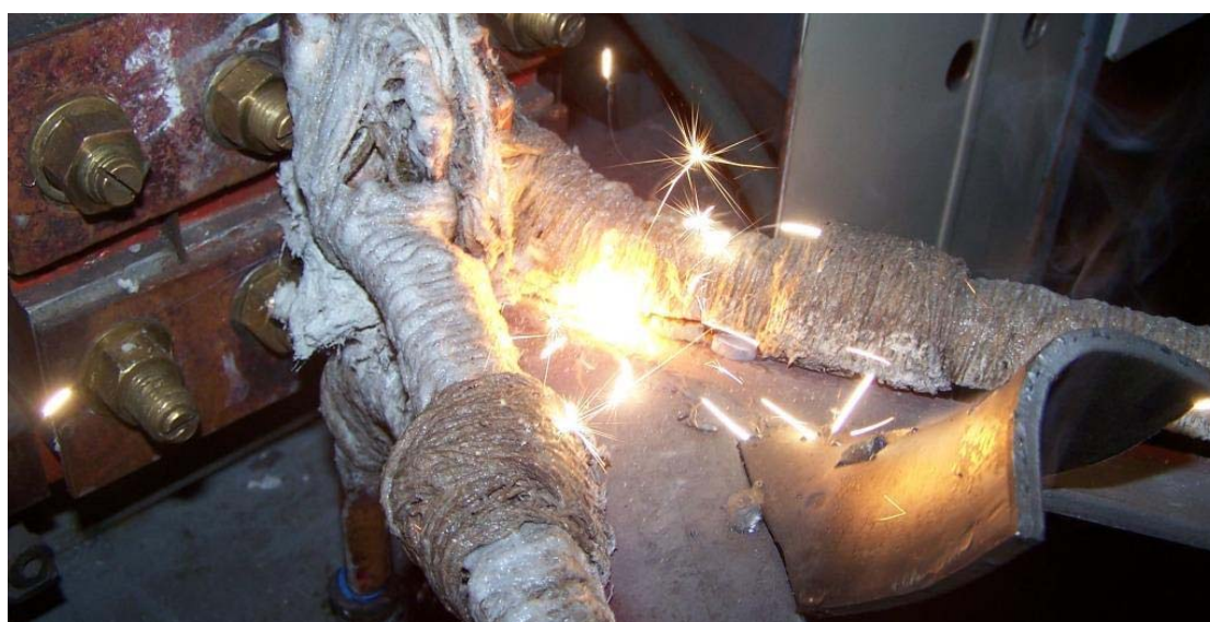
Рис. 2. Воспламенение термоиндикатора на поверхности детали, нагреваемой токами высокой частоты
