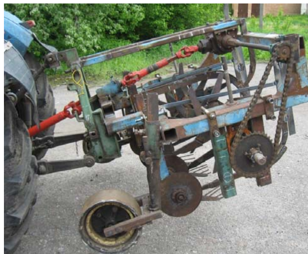
Рис. 2. Почвообрабатывающая полевая установка на базе роторного культиватора КПП-1
