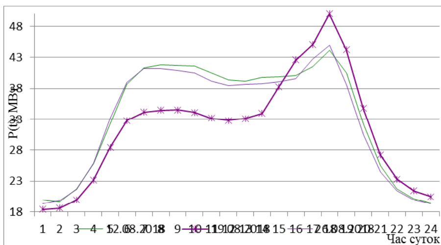
Рис. 2. Суточный график электрической нагрузки ГТП «Южная» при отключении холодной воды в г. Рубцовске
