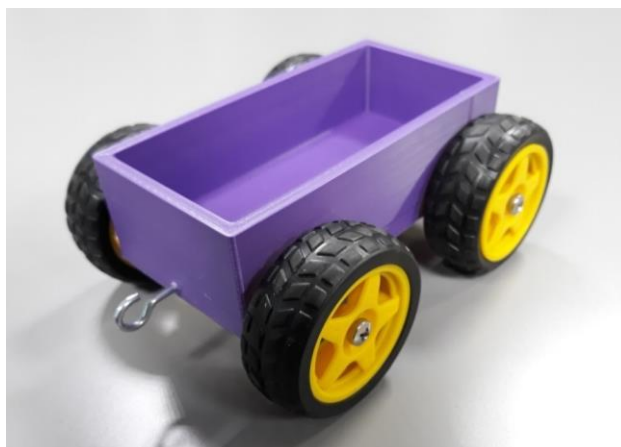
Рисунок 3 – Прицеп. Внутренние размеры кузова прицепа (ДхШхВ) 140х65х35 мм, высота дна кузова относительно пола 40 мм.
