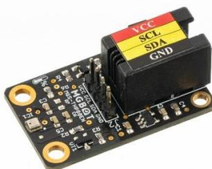
Датчик температуры, влажности воздуха и атмосферного давления соответственно измеряет температуру, влажность воздуха и атмосферное давление.
