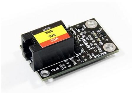
Датчик освещенности предназначен для измерения фонового освещения. Имеет высокую чувствительность и распространенный последовательный интерфейс I2C. Спектр чувствительности совпадает с кривой чувствительности человеческого глаза.
