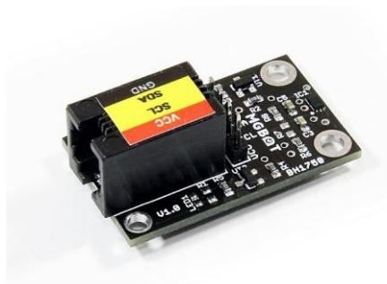
Датчик освещенности предназначен для измерения фонового освещения. Имеет высокую чувствительность и распространенный последовательный интерфейс I2C. Спектр чувствительности совпадает с кривой чувствительности человеческого глаза.
