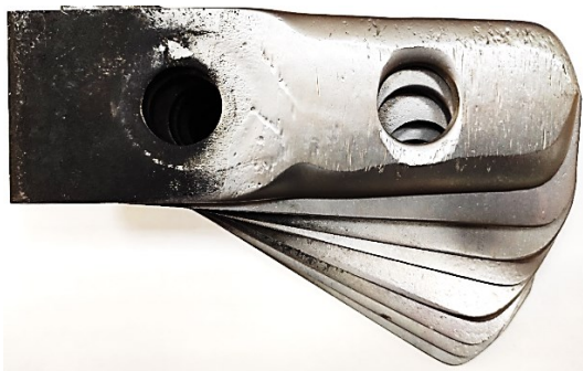
Рис. 1. Внешний вид изношенных молотков всех 8-и секций одной стопки (наработка 135-145 т)
