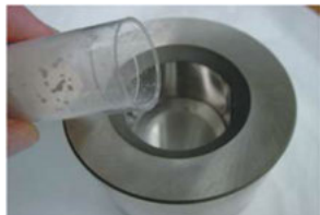
Pour the mix into the die
