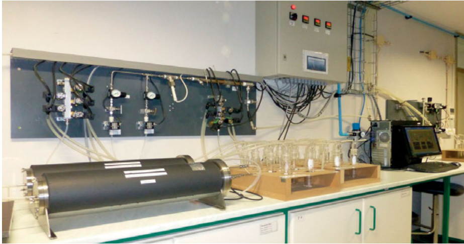
Fig. 8.5: Gas analysis method (EN 717-2).
