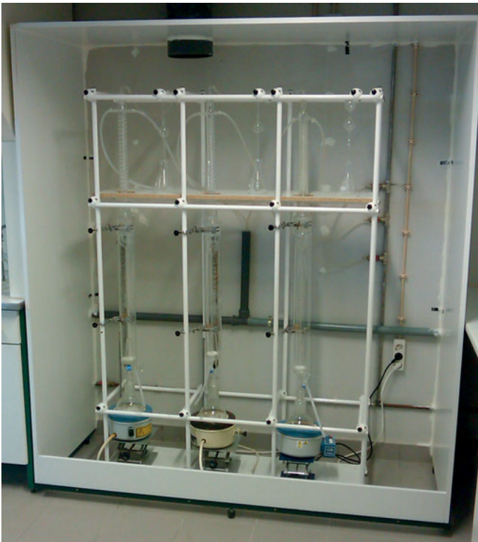
Fig. 8.3: Perforator method (EN 120).
