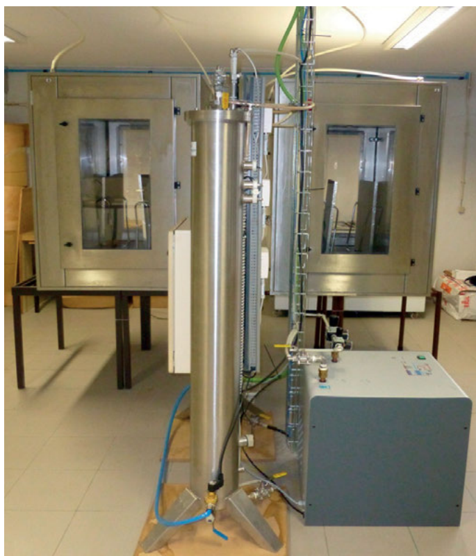
Fig. 8.4: Chamber method (EN 717-1: 1 m 3 ).
