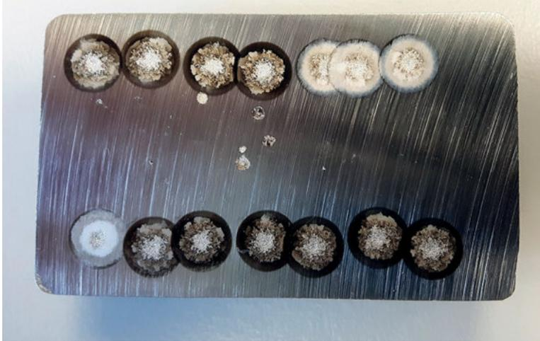
**Abb. 3.23:** Brennflecke mit hohem (links unten) und niedrigem (rechts unten) Anteil diffuser Entladungen, Abdruck mit freundlicher Genehmigung der Firma SPECTRO Analytical Instruments GmbH, Boschstr. 10, 47533 Kleve
