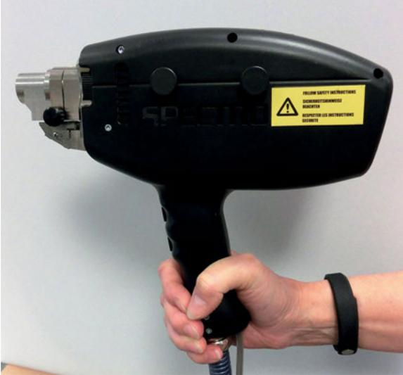
**Abb. 3.4:** Funkensonde Spectro-Test, Abdruck mit freundlicher Genehmigung der Firma SPECTRO Analytical Instruments GmbH, Boschstr. 10, 47533 Kleve
