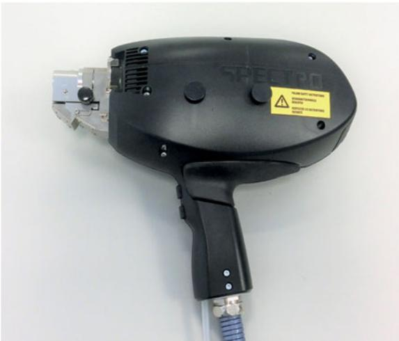
**Abb. 3.5:** Funkensonde mit UV-Sonde SpectroTest, Abdruck mit freundlicher Genehmigung der Firma SPECTRO Analytical Instruments GmbH, Boschstr. 10, 47533 Kleve
