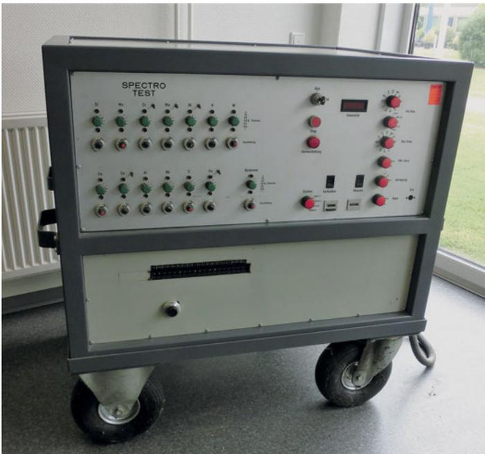
**Abb. 6.14:** Frühes Mobilspektrometer zur Verwechslungsprüfung, Baujahr 1980, Abdruck mit freundlicher Genehmigung der Firma SPECTRO Analytical Instruments GmbH, Boschstr. 10, 47533 Kleve
