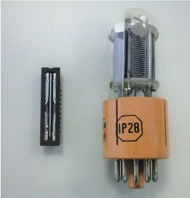
**Abb. 3.46:** CCD-Chip (links) und Photomultiplier (rechts) Abdruck mit freundlicher Genehmigung der Firma SPECTRO Analytical Instruments GmbH, Boschstr. 10, 47533 Kleve
