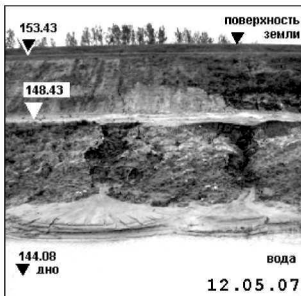
Рис. 4. Молодые эрозионные формы на склоне северной экспозиции между насосными станциями НС и НС3
