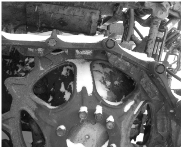
Рис. 9. Гусеница, оснащенная РМШ
