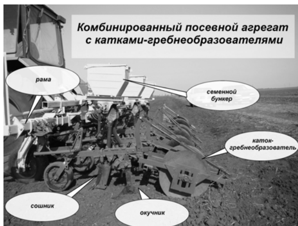
Рис. 1. Комбинированный посевной агрегат
