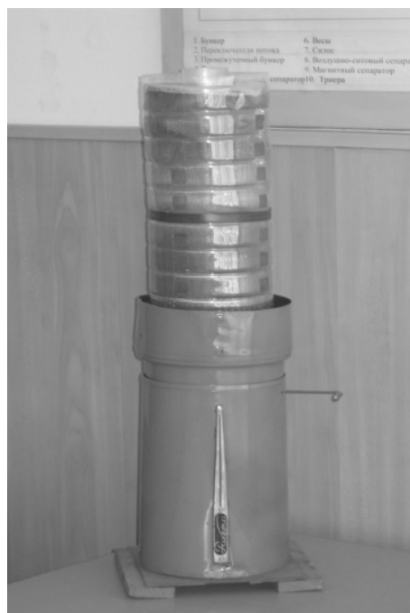
Рис. 2. Экспериментальная установка предлагаемого бункера активного вентилирования
