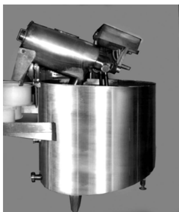
Рис. 2. Осветлитель сыворотки Фирмы «Tescolat» (Италия)
