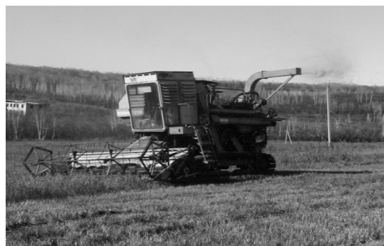
Рис. 1. Приспособление к зерноуборочному комбайну для сбора соевой половы
