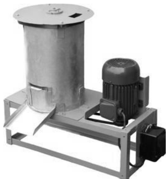
Рис. 1. Схема и общий вид смесителя: 1 – емкость смесителя; 2 – вертикальный вал; 3 – мешалка; 4 – заслонка; 5 – выгрузной лоток; 6 – загрузочный бункер; 7 – рама; 8 – электродвигатель мощностью 2,2 кВт; 9 – клиноремённая передача
