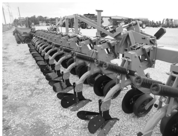
Рис. 9. Рабочие органы фирмы Hiniker в конструкции в виде рядовой мотыги [www.hiniker.com]
