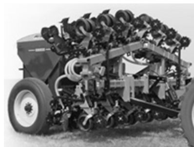
Рис. 2. Типовая машина для Strip-till из Северной Америки
