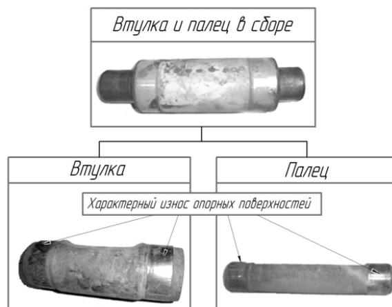
Рис. 1. Виды износа деталей сопряжения «втулка-палец» трака бульдозера KOMATSU
