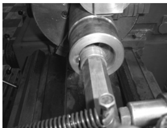
Рис. 4. ЭМПЗ втулки: а — наружной поверхности; б — внутренней поверхности
