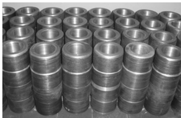
Рис. 9. Втулки трака бульдозера KOMATSU после ЭМПЗ
