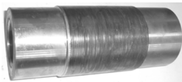
Рис. 8. Окончательный вид втулки после изготовления по предлагаемой технологии ЭМПЗ
