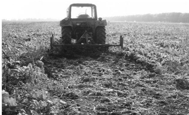
Рис. 2. Скашивание ботвы свеклы экспериментальным устройством
