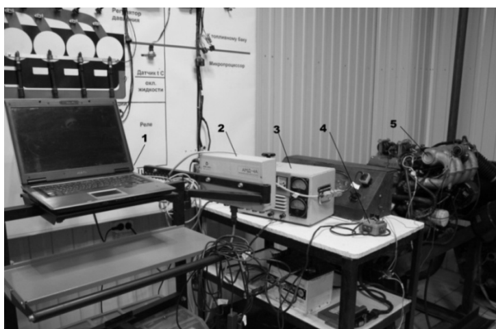
Рис. 2. Общий вид экспериментальной установки: 1 – персональный компьютер; 2 – мотор-тестер МТ-10; 3 – блок питания; 4 – устройство включения-выключения электромагнитных форсунок; 5 – двигатель ЗМЗ 4062.10
