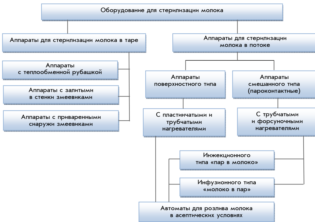
Рис. 2. Схема классификации оборудования для стерилизации молока
