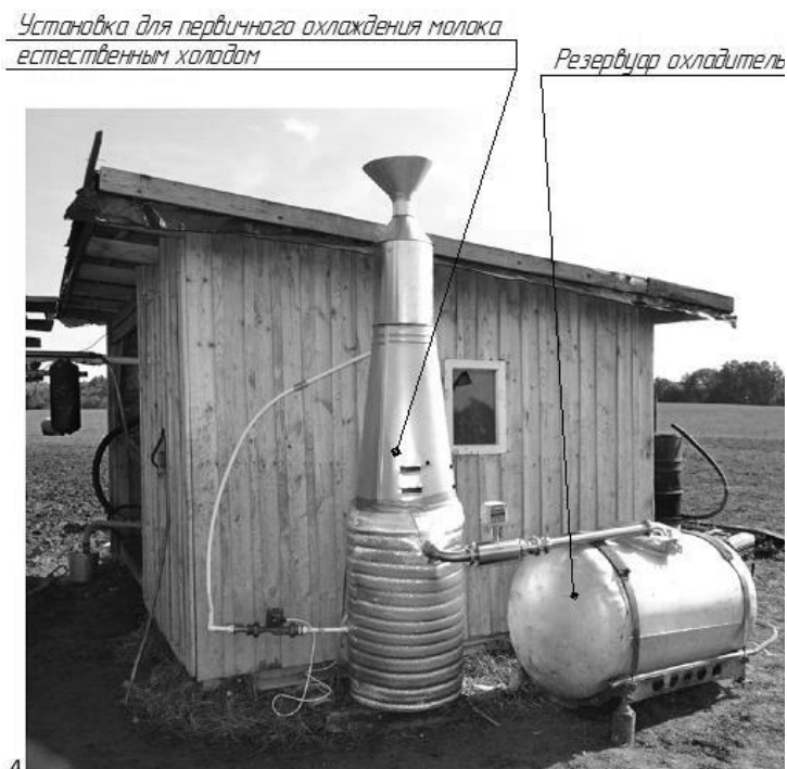
Рис. 3. Технологический процесс первичного охлаждения и доохлаждения молока на пастбищном комплексе ООО «СПК-колхоз Маевский»
