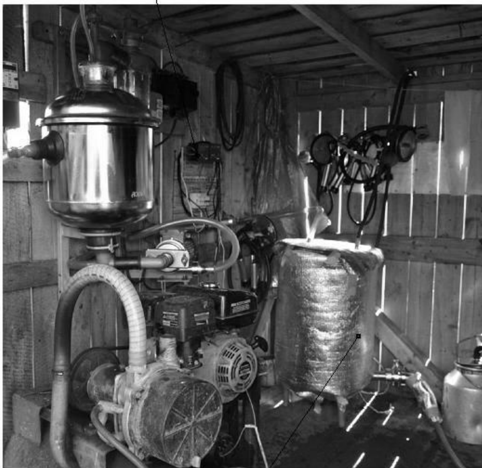
Рис. 2. Установка для термизации молока на пастбищном комплексе ООО «СПК-колхоз Маевский» Новоскольнического района Псковской области
