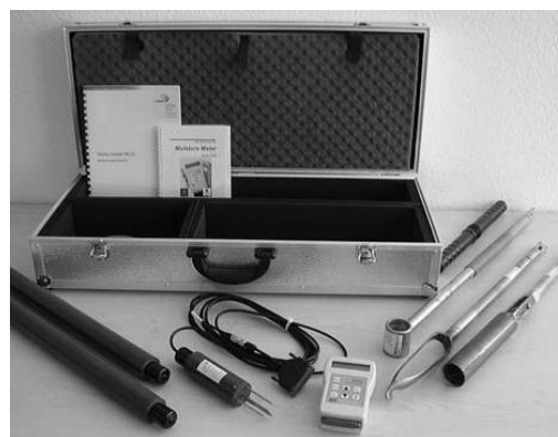
Рис. 1. Ручной прибор-индикатор NH2 Moisture Meter, Гидрозонд FDR ML2x «Эко-Тех», ФРГ
