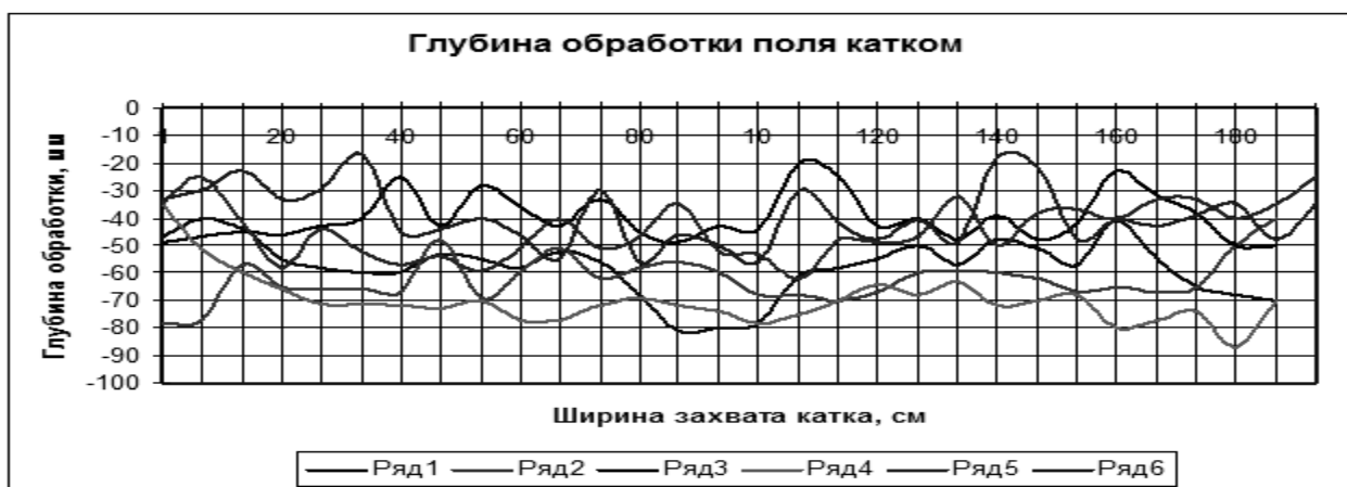
Рис. 7. Профиль дна борозды после прохода бороны с кольцевыми катками
