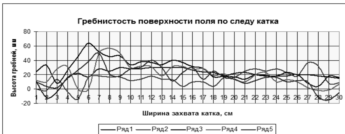
Рис. 6. Профиль поля после прохода бороны с кольцевыми катками
