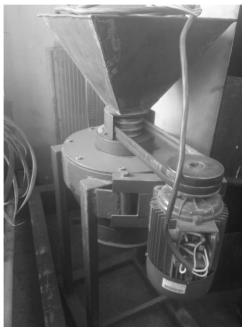
Рис. 1. Общий вид разработанного центробежного обрушивателя
