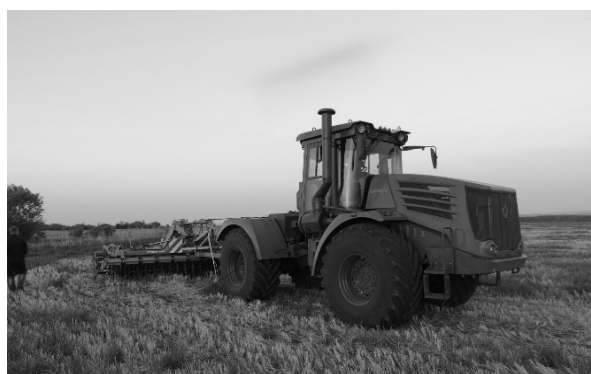
Рис. 1. Дисковое почвообрабатывающее орудие А-6002 «Агродиск» в агрегате с трактором К-9450 «Кировец»
