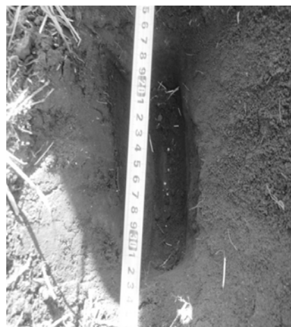
Рис. 4. Распределение удобрений в обрабатываемой полосе после прохода агрегата
