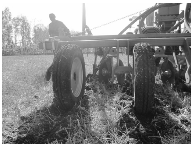
Рис. 3. Рабочий проход комбинированного агрегата для технологии «Strip-Till» при закладке полевого опыта
