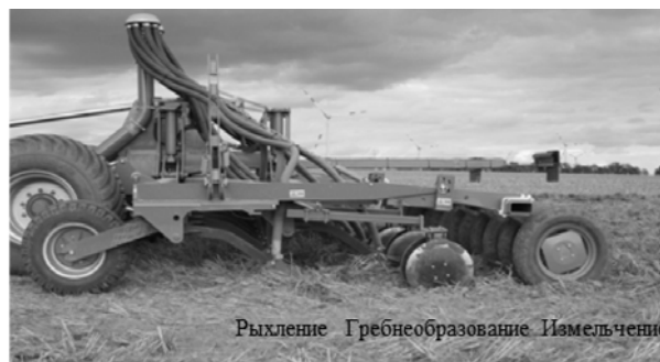
Рис. 1. Почвообрабатывающая машина для технологии «Strip-Till»
