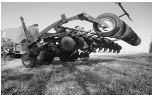
Рис. 2. Почвообрабатывающий агрегат для технологии «Strip-Till»
