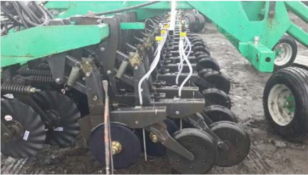
Рис. 6. Переоборудование посевного комплекса для внесения жидких удобрений
