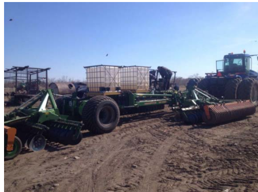
Рис. 9. Переоборудование дисковой бороны «Catros» для внесения почвенных гербицидов
